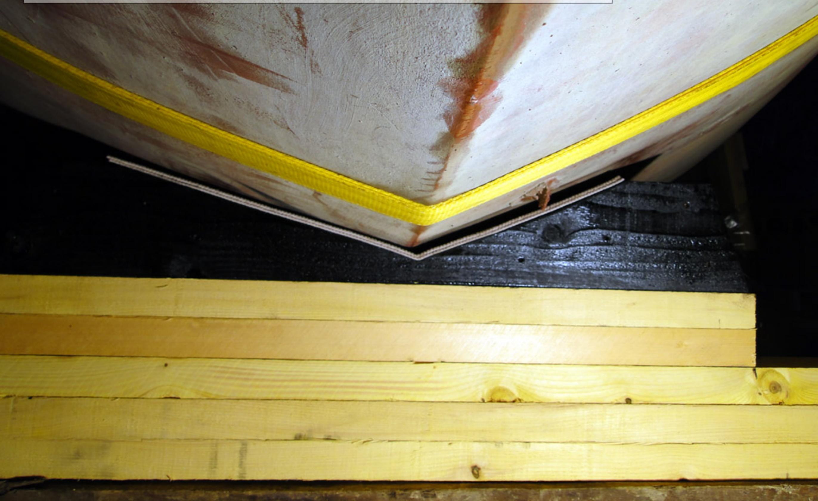
**Dépose et calage, la forme de la coque est assez régulière à ce niveau.
